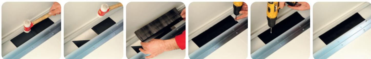
Нижний модуль шкафа оборудован увеличенным кабельным вводом, закрытым металлической выбивной пластиной, легко удаляемой для заведения кабеля через пол шкафа.
