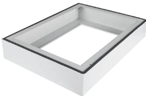
Цоколь высотой 100 мм приподнимает шкаф при напольной установке на бетонное покрытие, создавая пространство для запаса кабеля. Крепится к полу при помощи винтов и гаек M12, не входящих в комплект поставки.
