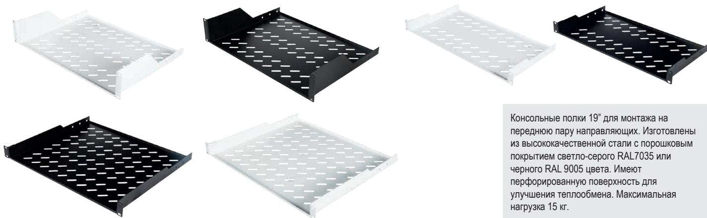
Консольные полки 19" для монтажа на переднюю пару направляющих. Изготовлены из высококачественной стали с порошковым покрытием светло-серого RAL7035 или черного RAL 9005 цвета. Имеют перфорированную поверхность для улучшения теплообмена. Максимальная нагрузка 15 кг.
