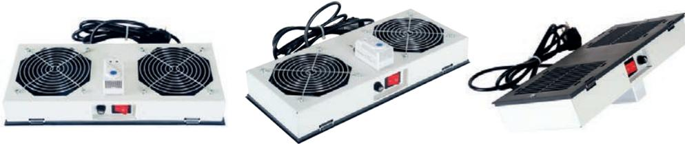
Готовый к эксплуатации вентилятор с аналоговым термостатом с операционным режимом 0-60°C. Теплоотведение каждого вентилятора 2,63-3,03 куб.м/мин. Технические характеристики вентилятора: 13,8/11,8Вт, 220/240В Ас, 50/60Гц, 0,14/0,12А, 2550/2750об/мин, 43-47дБ. Срок службы: 50000ч при 40°C.
