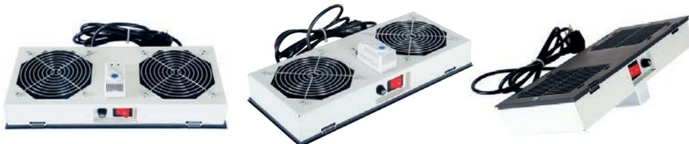
Готовый к эксплуатации вентмодуль с аналоговым термостатом с операционным режимом 0-60°C. Теплоотведение каждого вентилятора 2,63-3,03 куб.м/мин. Технические характеристики вентилятора: 13,8/11,8Вт, 220/240В Ас, 50/60Гц, 0,14/0,12А, 2550/2750об/мин, 43-47дБ. Срок службы: 50000ч при 40°C.
