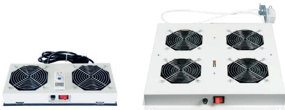
Готовый к эксплуатации вентмодуль с аналоговым термостатом с операционным режимом 0-60°C. Теплоотведение каждого вентилятора 2,63-3,03 куб.м/мин.
