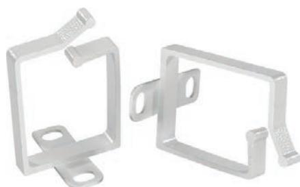
Кабельные кольца используются для организации разводки кабельных линий внутри шкафа. В комплект входят 5 металлических колец размером 44x30мм, окрашенных в светло-серый RAL7035 цвет. Саморезный крепеж позволяет закрепить кольца на внутренние панели шкафов с двойными стенками.
