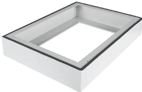
Цоколь высотой 100 мм приподнимает шкаф при напольной установке на бетонное покрытие, создавая пространство для запаса кабеля. Крепится к полу при помощи винтов и гаек M12, не входящих в комплект поставки.
