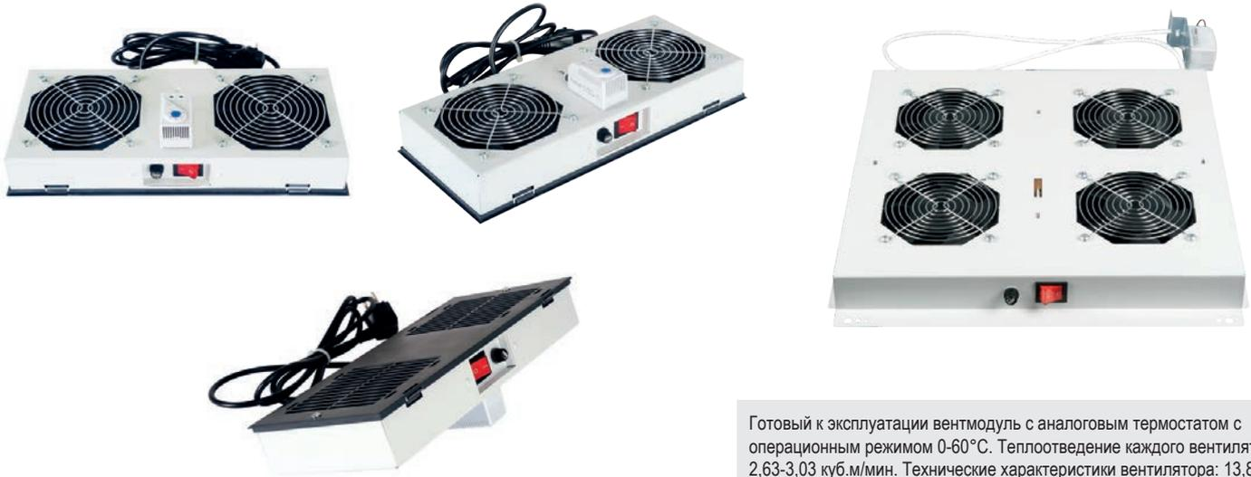
Готовый к эксплуатации вентмодуль с аналоговым термостатом с операционным режимом 0-60°C. Теплоотведение каждого вентилятора 2,63-3,03 куб.м/мин. Технические характеристики вентилятора: 13,8/11,8 Вт, 220/240В Ас, 50/60Гц, 0,14/0,12А, 2550/2750об/мин, 43-47дБ. Срок службы: 50000ч при 40°C.
